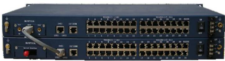
Оборудование передачи телефонных линий на 60 абонентов это уже серьезное решение для многоэтажных домов. Целый подъезд многоэтажного многоквартирного дома (например 15-ти этажного по 4 квартиры на этаже) достаточно оснастить одним комплектом NO-T60-20 и полностью обеспечить жильцов данного подъезда стабильной потоковой телефонной связью.
